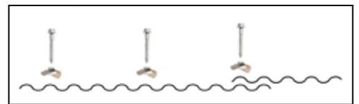
Installer les tôles en les superposant d'au moins 2 ondulations.
